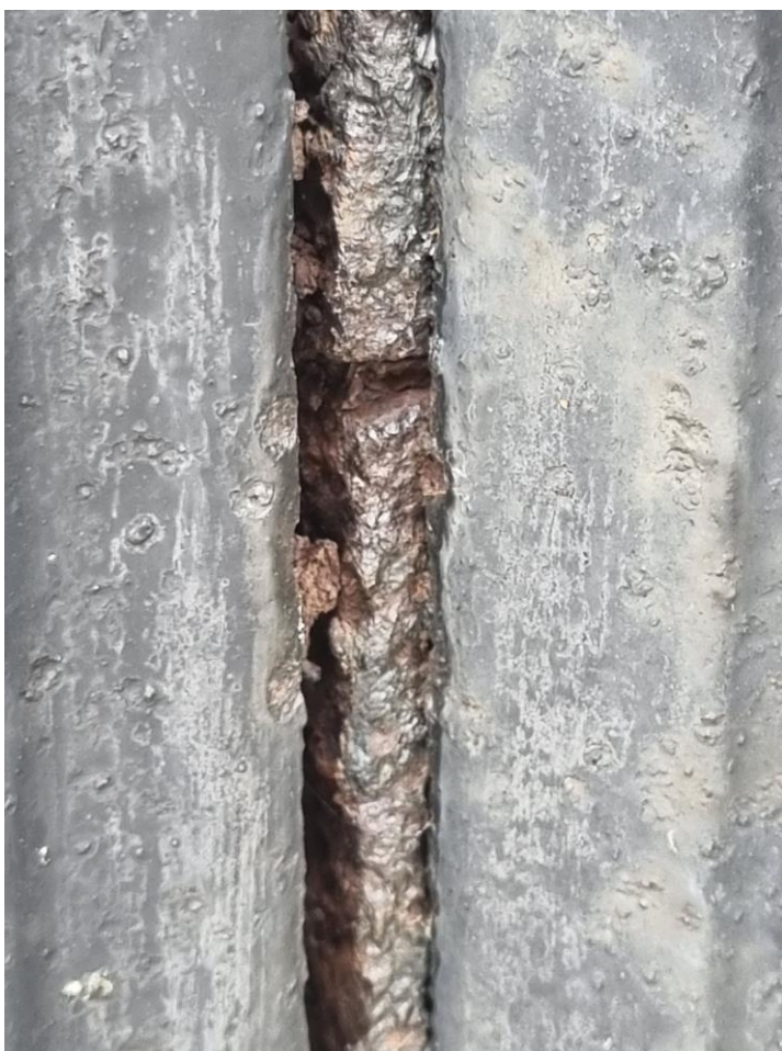
Detailní pohled na roztržené pláty litiny těla podstavce.
